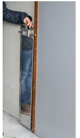
La porte de sortie du bâtiment a été équipée du système « Défect porc » commercialisé par la Société Berthelot en partenariat avec Orela. Ce système, qui permet de bloquer les portes pendant le passage des porcs, s'adapte à toutes sortes d'élevages.
